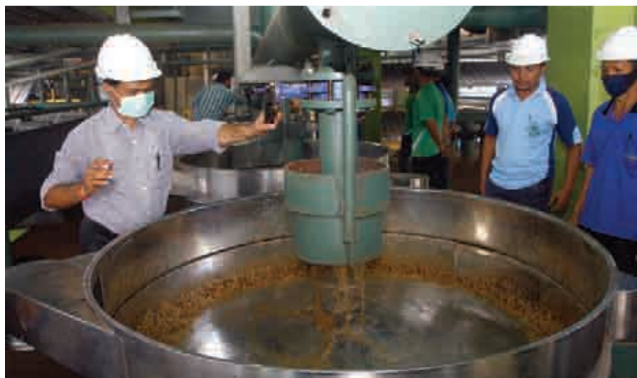
■ Instruktur dari India menunjukkan cara kerja mesin fosfatasi untuk menghasilkan Gula Premium.
